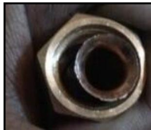
Si el Torque aplicado es muy fuerte, la embocadura es dañada ☐ Fuga de Gas
