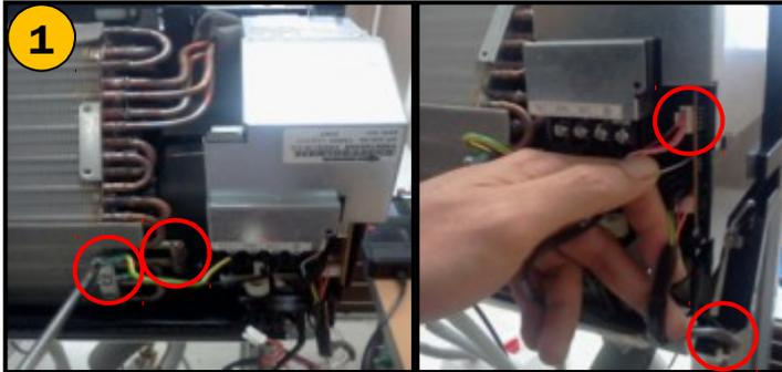
Asegúrese de desconectar todas las conexiones de los cables, sensores, etc. de la caja de control
