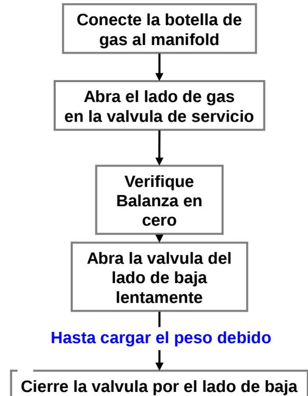
Busque en el manual de instalacion los datos de peso(g) / longitud de tuberia (m)
