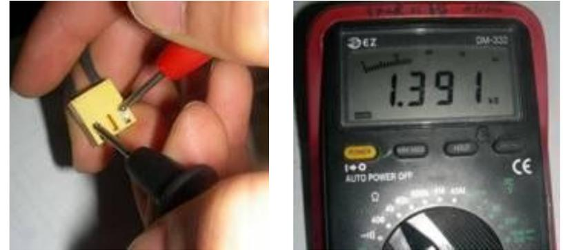
1. Ajuste el multímetro en modo Resistencia.
